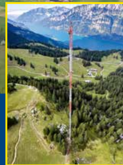
Windmessmast auf Flumserberg: Bevor gebaut wird, misst man den Wind – wie hier im Kanton St. Gallen.
